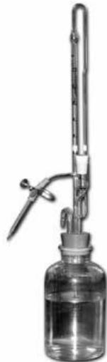
Este dispositivo permite efectuar una medición de la acidez de la leche expresada en grados Dornic. El acidímetro es un instrumento de sencilla fabricación por lo que se puede encontrar en cualquier negocio de venta de materiales para medición de laboratorios e, inclusive, en algunas farmacias. De igual manera la solución de Hidróxido de Sodio N/9.
