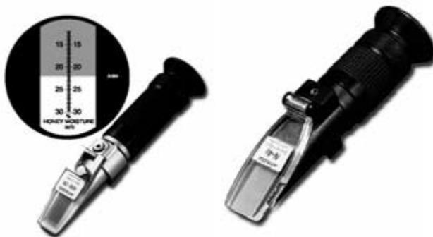
El refractómetro es un pequeño instrumento que permite estimar la cantidad de sólidos presentes en un fluido, y que determina el punto final del proceso de calentamiento. Se lo usa también con el mismo fin para la elaboración de miel y mermeladas. En general la unidad de
